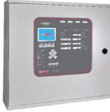
Centrale di rivelazione LEONIS, analogica indirizzata da **1 loop da 256 indirizzi espandibile a 4 loop**, in contenitore metallico, gestisce fino a **512 indirizzi** complessivi distribuiti su 4 loop. Completa di alimentatore, pannello di gestione e comando, display LCD grafico a colori da 3,5", 2 relè liberamente programmabili, uscita ausiliaria 24 Vcc 400 mA, porta USB, 2 ingressi programmabili. Certificata EN54-2, EN54-4 ed EN54-13. **Consente alloggiamento di 2 batterie da 18 A/h**
