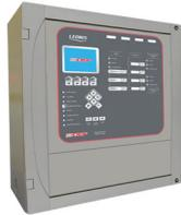
Centrale di rivelazione LEONIS, analogica indirizzata da **1 loop da 256 indirizzi espandibile a 4 loop**, in **contenitore metallico LARGE**. Gestisce fino a **512 indirizzi** complessivi distribuiti su 4 loop. Completa di alimentatore, 2 relè liberamente programmabili, uscita ausiliaria 24 Vcc 400 mA, porta USB, 2 ingressi programmabili. Certificata EN54-2 EN54-4 ed EN54-13. **Consente alloggiamento di 2 batterie da 42 A/h**
