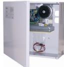
Unità di alimentazione 24 Vcc 12 A. Certificata CE CPD EN54-4 A2 e EN12101-10 per i sistemi di controllo a norma di evacuatori di fumo e calore. Batteria allocabile 2 x 24 Ah 12 V. Corrente disponibile per carichi esterni 10,2 A. Contenitore metallico (425 x 510 x 210 mm). Uscite a relè per mancanza rete, guasto batterie e guasto uscita
