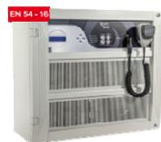
Sistema allarme vocale **compatto da parete 1 Zona di allarme 2 Linee di diffusione max. 400W**. Monitoraggio della linea dell'amplificatore e dell'altoparlante. Microfono di emergenza UPS integrato (batterie non fornite) **Possibilità di configurare un amplificatore di soccorso (300W), in questo caso il sistema gestirà una linea di diffusione.** Certificato EN54-16
