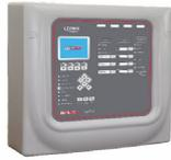
Centrale di rivelazione LEONIS, analogica indirizzata da **1 loop da 256 indirizzi espandibile a 2 loop**, in contenitore plastico. Gestisce fino a **512 indirizzi** complessivi distribuiti su 2 loop. Completa di alimentatore, pannello di gestione e comando, display LCD grafico a colori da 3,5", 2 relè liberamente programmabili, uscita ausiliaria 24 Vcc 400 mA, porta USB, 2 ingressi programmabili. Certificata EN54-2, EN54-4 ed EN54-13. **Consente alloggiamento di 2 batterie da 12 A/h**
