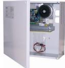
Unità di alimentazione 24 Vcc 4 A. Certificata CE CPD EN54-4 A2 e EN12101-10 per i sistemi di controllo a norma di evacuatori di fumo e calore. Batteria allocabile 2 x 24 Ah 12 V. Corrente disponibile per carichi esterni 3A. Contenitore metallico CM02 (385 x 405 x 160 mm). Uscite a relè per guasto generale e mancanza rete
