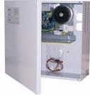
Unità di alimentazione 24 Vcc 2 A. Certificata CE CPD EN54-4 A2 e EN12101-10 per i sistemi di controllo a norma di evacuatori di fumo e calore. Batteria allocabile 2 x 12 Ah 12 V. Corrente disponibile per carichi esterni 1,5 A. Contenitore metallico CM02 (385 x 405 x 160 mm). Uscite a relè per guasto generale e mancanza rete
